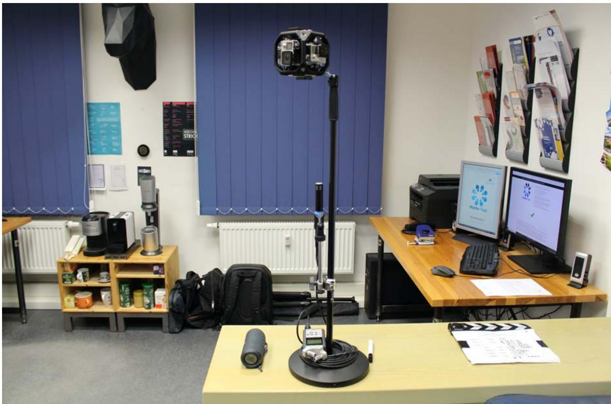
Abbildung 9: 360°-Kamera und Stützmikrofon für Referenzaufnahmen (Foto: Simon Lamche)
