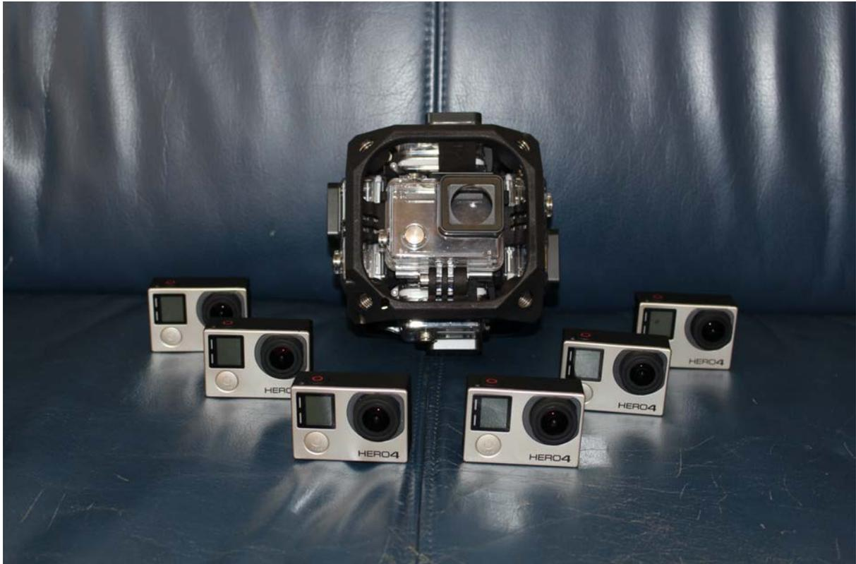
Abbildung 1: 360°-Rig und Actioncams zur Aufnahme von 360°-Videos (Foto: Simon Lamche)
